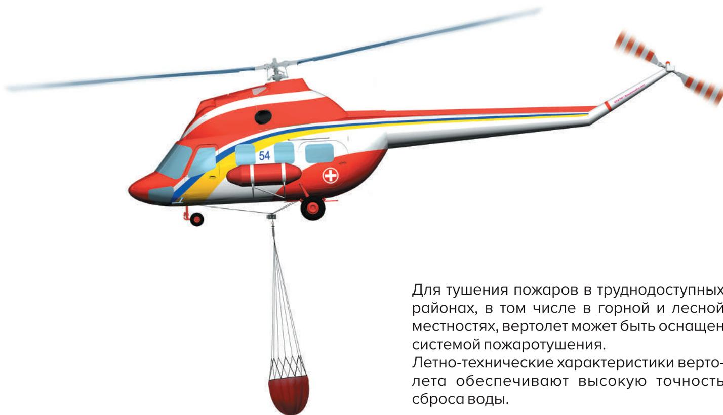
Для тушения пожаров в труднодоступных районах, в том числе в горной и лесной местностях, вертолет может быть оснащен системой пожаротушения.
