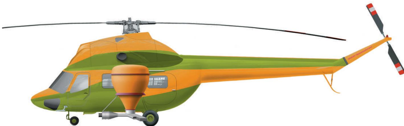
Установка специального оборудования позволяет производить с воздуха распыление сыпучих и разбрызгивание жидких химикатов, применяемых для работ в сельском хозяйстве. Сельхозаппаратура включает в себя систему опрыскивания и систему опыливания. В обеих системах используется один комплект баков. Системы легкосъёмные, монтаж и демонтаж может производиться и в полевых условиях.
